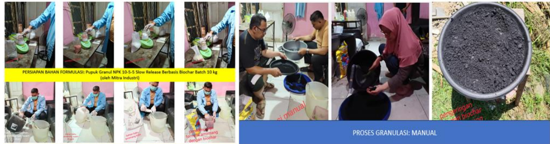
Gambar 5. Formulasi pupuk arromang untuk batch 10 kg untuk kepentingan identifikasi kinerja bahan untuk transformasi bentuk cair ke bentuk padat (granul) (PT-Mitra)
